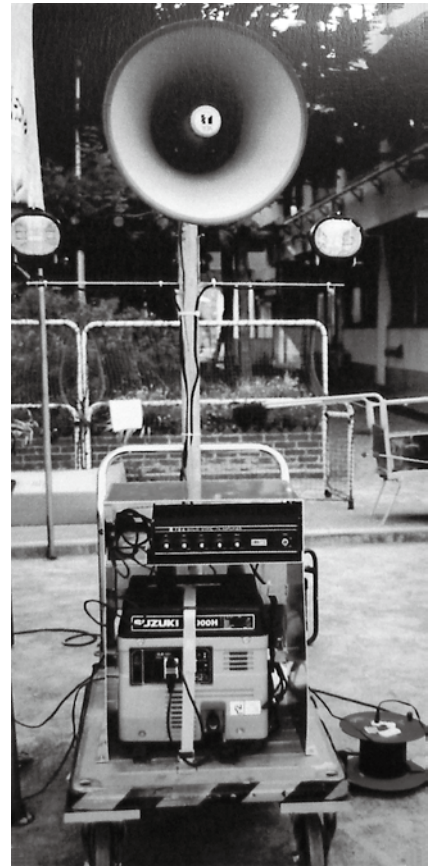
移動放送設備
